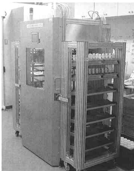
土日対応自動BOD測定システム
